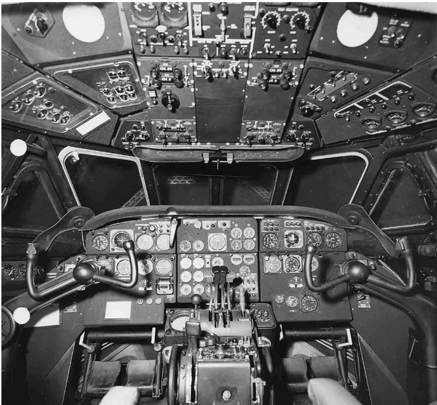
▲ ▼ Le poste de pilotage d'une Caravelle d'Air Algérie et Léopold Galy, pilote d'essais, qui a participé sur les trajets Orly-Maison-Blanche et Orly-La Sènia, à l'expérimentation de l'équipage à deux pilotes
